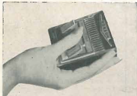
Fig. 2 - Il trasmettitore SC88/T ha quattro pulsanti: il primo per accendere e spegnere, il secondo per regolare il volume sonoro, il terzo per regolare il contrasto dell'immagine ed il quarto per attuare la commutazione dei canali.
