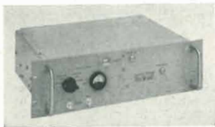
Nella foto: il generatore 103 AR controllato a quarzo e ad alta stabilità, costruito dalla HEWLETT PACKARD Co. Si tratta di un generatore avente stabilità su lunghi periodi di 5 parti su 10^{10} al giorno. Compatto e completamente transistorizzato è un tipico esempio di strumento realizzato secondo criteri moderni. Esso fornisce due segnali sinusoidali, uno a 1 MHz, il secondo a 100 kHz con impedenza interna di 50 \Omega
